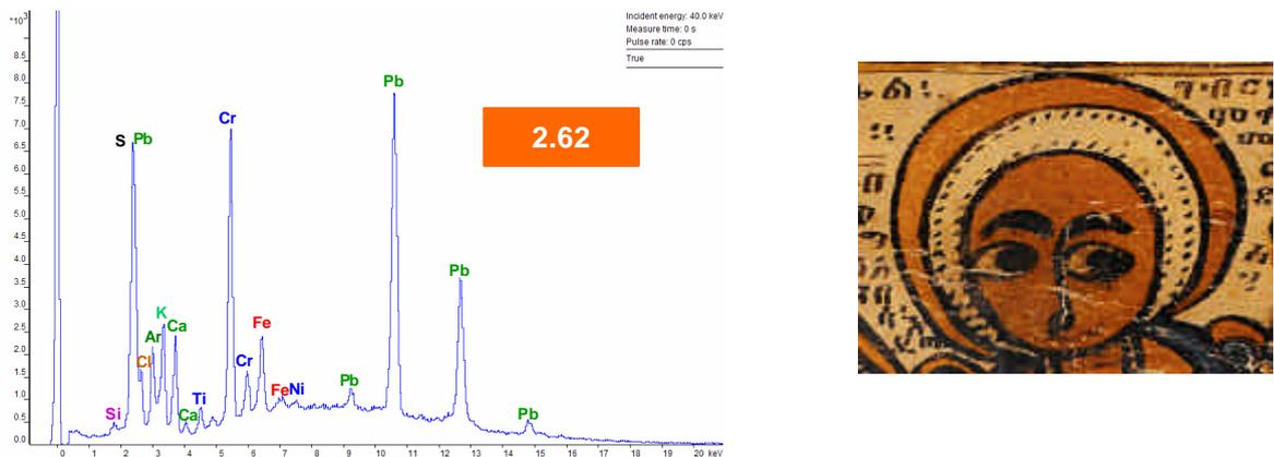
Figure 9 - Spectre de fluorescence X du pigment orange du rouleau 2.62 = **orange de chrome**  $PbCrO_4$ ,  $PbO$
