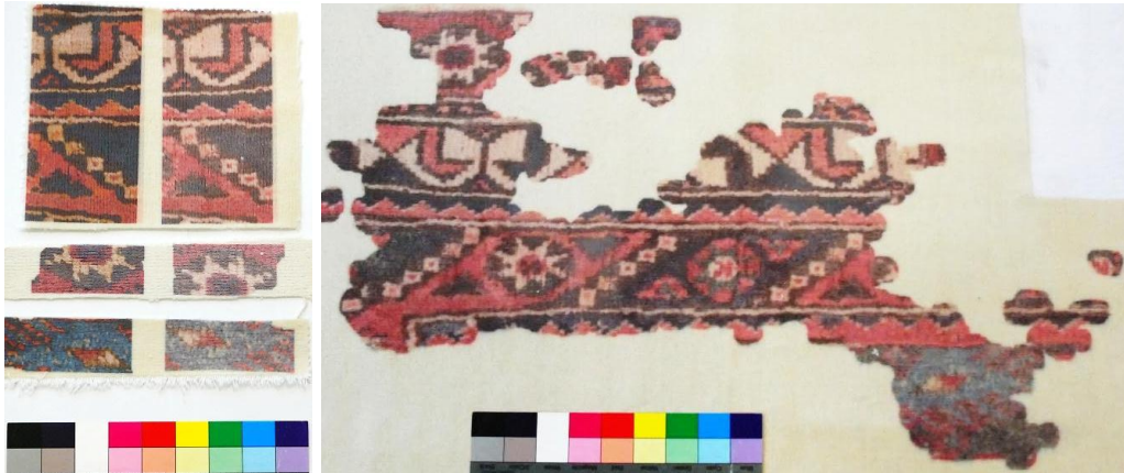
Figure 116 : Essais sur le velours 70% polyester et 30% coton : comparaison entre « catégorie 4 » (bande de gauche) et « catégorie 1 » (bande de droite). L'ensemble de la lacune est imprimé en « catégorie 1 ». ©Inp/L.Metatla
