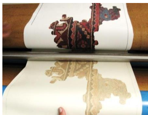
Figure 123 : tissu en polyester et papier transfert au sortir de la calandre, Plateforme eMODE.
